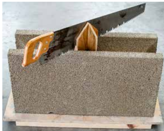
Figura 4: Plantilla de esquina de 90° simple y económica
